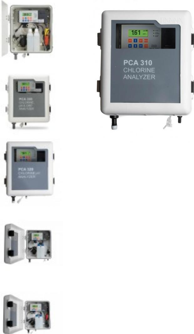
Los analizadores de cloro de la serie Hanna PCA monitorean, controlan y ajustan continuamente el contenido de cloro y el pH de un flujo de muestra. Análisis y dosificación en continuo mediante método colorimétrico: máxima precisión con reactivos DPD.
