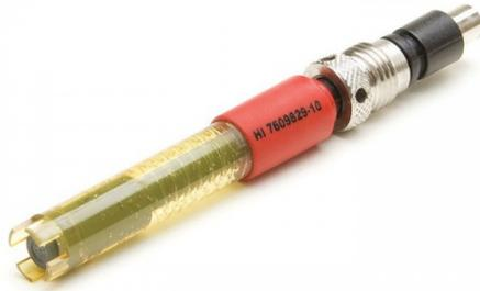
Electrodo combinado de membrana líquida utilizado para la detección de nitrógeno de amonio libre en muestras de agua dulce. Su diseño de doble unión contiene una cámara de referencia rellena de gel Ag / AgCl. El HI7609829-10 utiliza una membrana polimérica construida en una cabeza de PVC.
