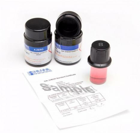
Los kit de patrones de calibración "CAL CHECK" trazable a NIST de Molibdeno HI96730-11, proporcionan una solución simple para calibrar y validar el fotómetro portátil HI96730. Este conjunto de estándares de alta calidad se suministra con un certificado de análisis que proporciona el número de lote, los valores de referencia y la fecha de caducidad para la trazabilidad al certificar fotómetros de molibdeno compatibles.
