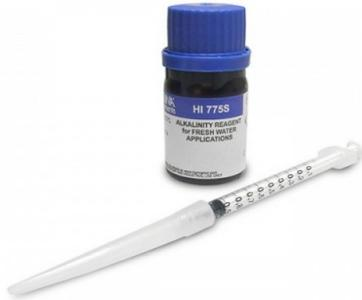
Este reactivo es necesario para realizar las medidas con el Medidor de bolsillo Checker HI775 de Alcalinidad.
