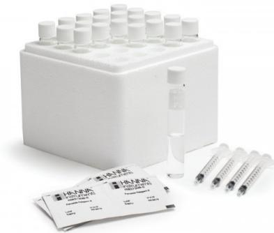
Conjunto de reactivos para el fotómetro HI83730 para la determinación del valor de peróxido en aceites de oliva. Un usuario puede determinar con precisión el valor de peróxido de aceite de oliva dentro de un rango de 0.0 a 25.0 meq O<sub>2</sub> / kg utilizando los reactivos HI83730-20.
