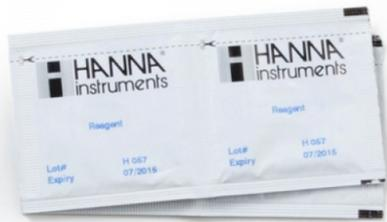
HI93712-0x son reactivos en polvo para la determinación colorimétrica del Aluminio (0,00 a 1,00 mg/L). Estos reactivos se pueden emplear en fotómetros de sobremesa y portátiles de Hanna Instruments.
