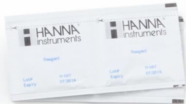
HI93705-0x son reactivos en polvo para la determinación colorimétrica del sílice. Estos reactivos se pueden emplear en fotómetros de sobremesa y portátiles de Hanna Instruments.
