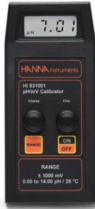
Simulador portátil de pH / mV diseñado específicamente para calibrar medidores de pH y mV (ORP).
