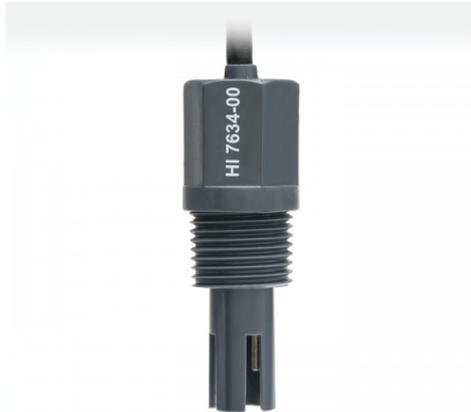
Es una sonda de conductividad y Solidos disueltos totales para mini controladores (BL983313/ BL983320/ BL983322) (BL983315/ BL983319/ BL983321/ BL983329) (BL983324) con sensor interno de temperatura, 3 bares de presión y 2 metros de cable
