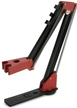
Soporte que proporciona mayor estabilidad y flexibilidad y sostiene hasta 3 electrodos en cualquier posición para usar con medidores de mesa de pH209.
