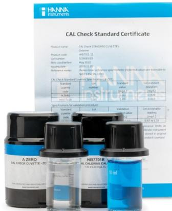
Kit de patrones de calibración que permite a los usuarios validar y calibrar los fotómetros portátiles de cloro libre que tienen un rango de medición de 0,00 a 5,00 mg / L (ppm). El kit HI97701-11 incluye una cubeta sellada "A" para poner a cero el medidor y una cubeta "B" que se utiliza para validar o calibrar.
