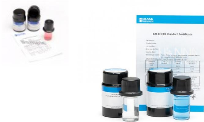
Kit de patrones de calibración que permite a los usuarios validar y calibrar los fotómetros portátiles de pH que tienen un rango de medición de 6.5 a 8.5 pH. El kit HI97710-11 incluye una cubeta sellada "A" para poner a cero el medidor y una cubeta "B" que se utiliza para validar o calibrar.
