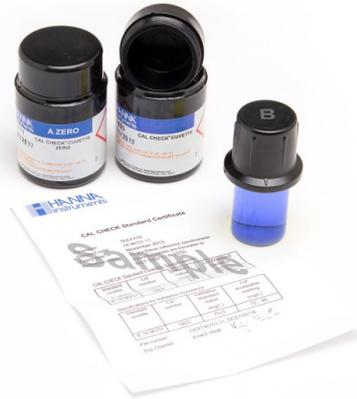
El kit de patrones HI97708-11 CAL Check™ proporciona una solución sencilla para calibrar y validar el fotómetro portátil HI97708.
